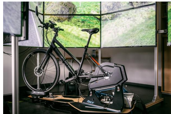
Abbildung 4.3.3-1: Fahrradsimulator der WIVW GmbH, betrieben mit der Fahrsimulationssoftware SILAB.
